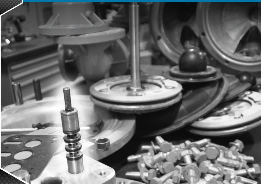
Das Steuerventil des Luftmotors ist das am häufigsten gewartete Teil von AODD-Pumpen.
