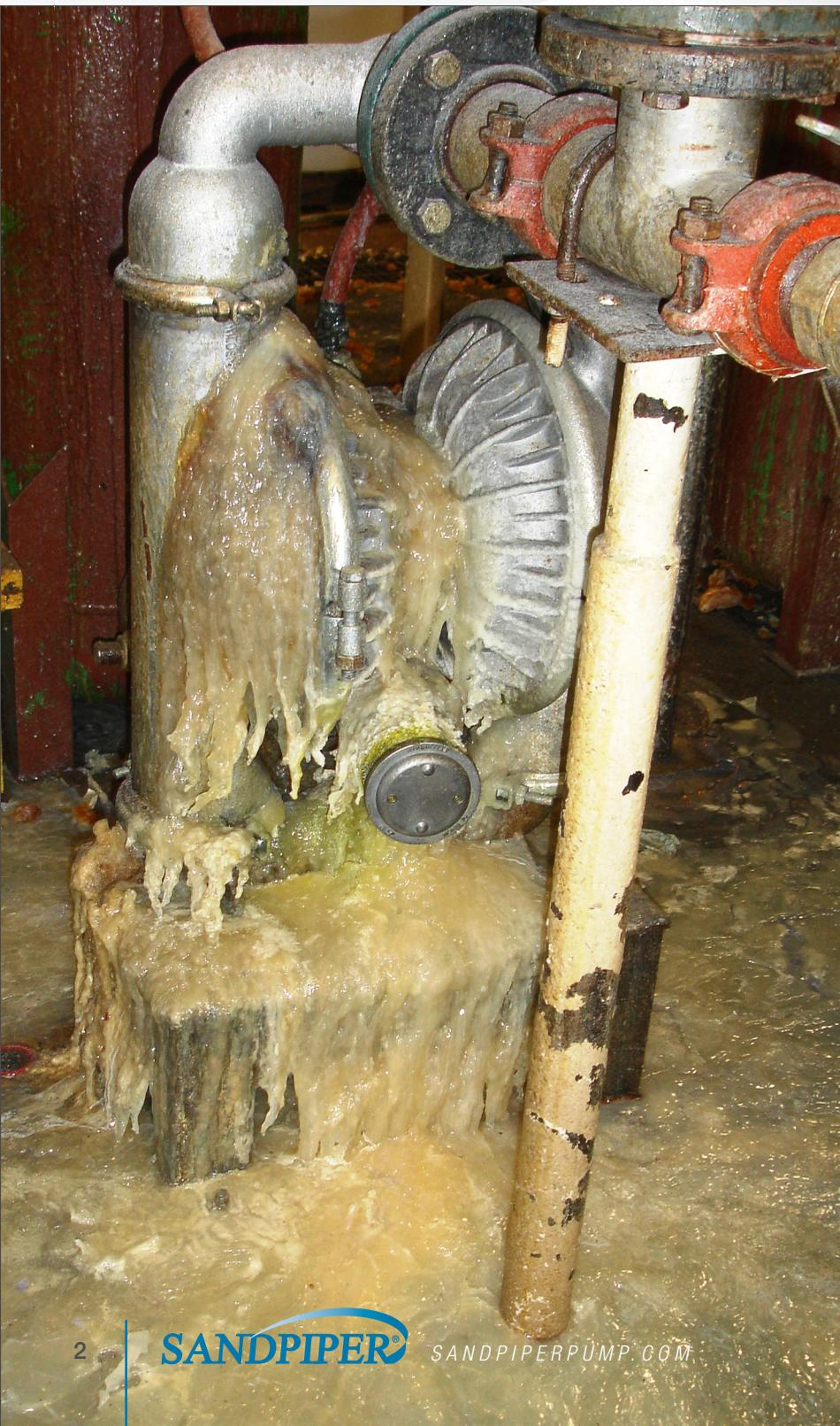
Wenn die Pumpmembran brechen sollte, gelangt die Flüssigkeit in das Luftverteilungssystem und tritt durch den Dämpfer in die Umgebung aus, sodass eine sofortige Reparatur erforderlich ist. Dies führt zu:
